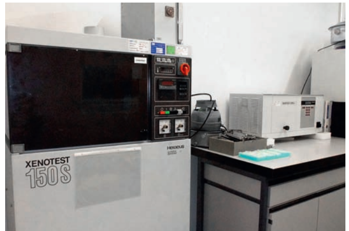
Mit den beiden Xenontester und dem Suntester führt die Ugra Lichtechtheitstests an Farben und anderen Materialien durch.
